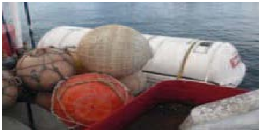
Figura 1 – Acesso obstruído a equipamento de salvatagem
